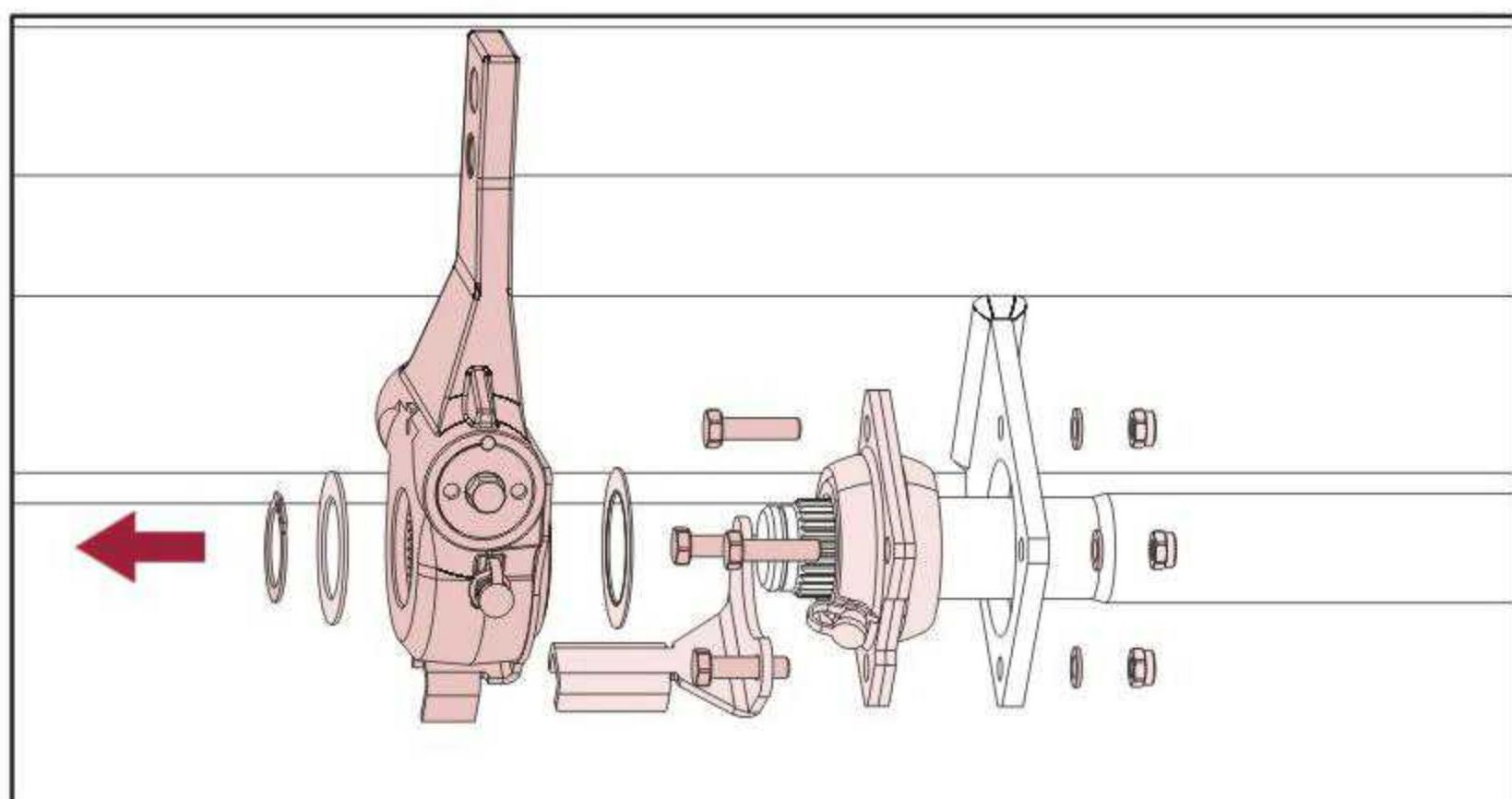
松开凸轮轴挡尘盖的管夹，取下挡尘盖，拆除凸轮轴卡簧和垫片并取下凸轮轴。
