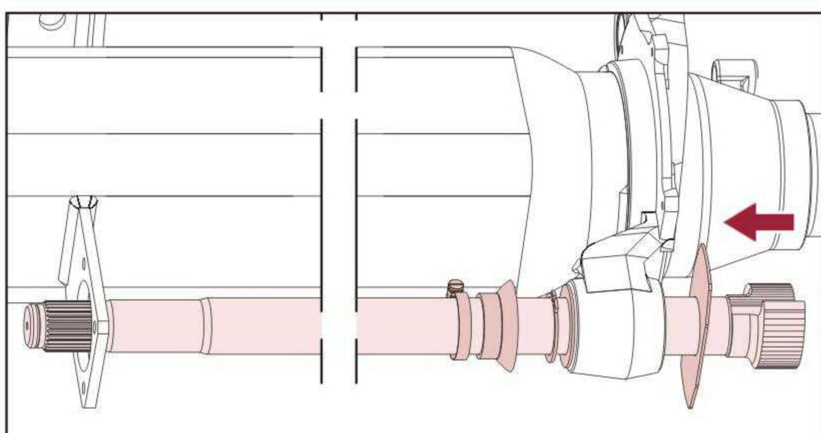
装球面轴承总成，按20Nm力矩拧紧球面轴承总成的螺栓/母。
