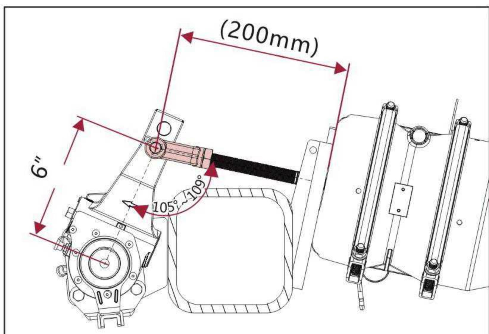
气室安装在轴体气室座上的B-B孔位上，螺母拧紧力矩为200Nm。
