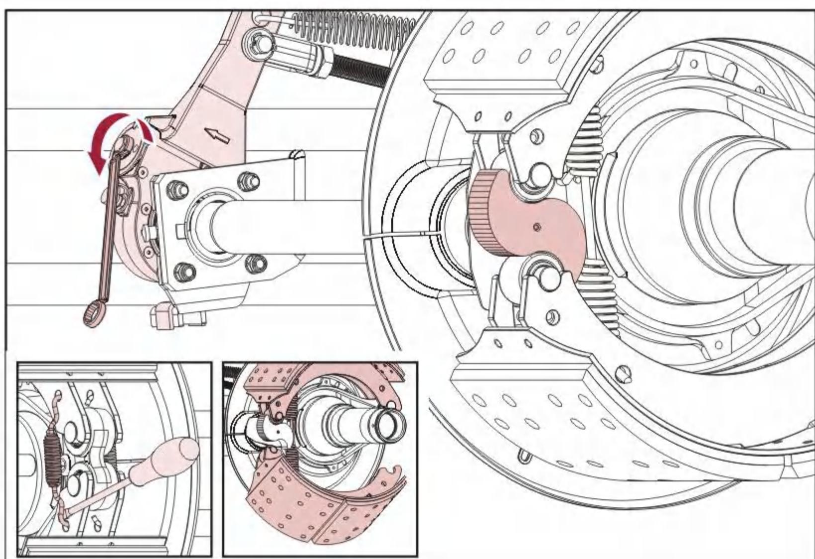
使用液压冲头将铆钉压出，拆下旧摩擦片，清洁制动蹄安装面，检查制动蹄是否变形、磨损或开裂等。
