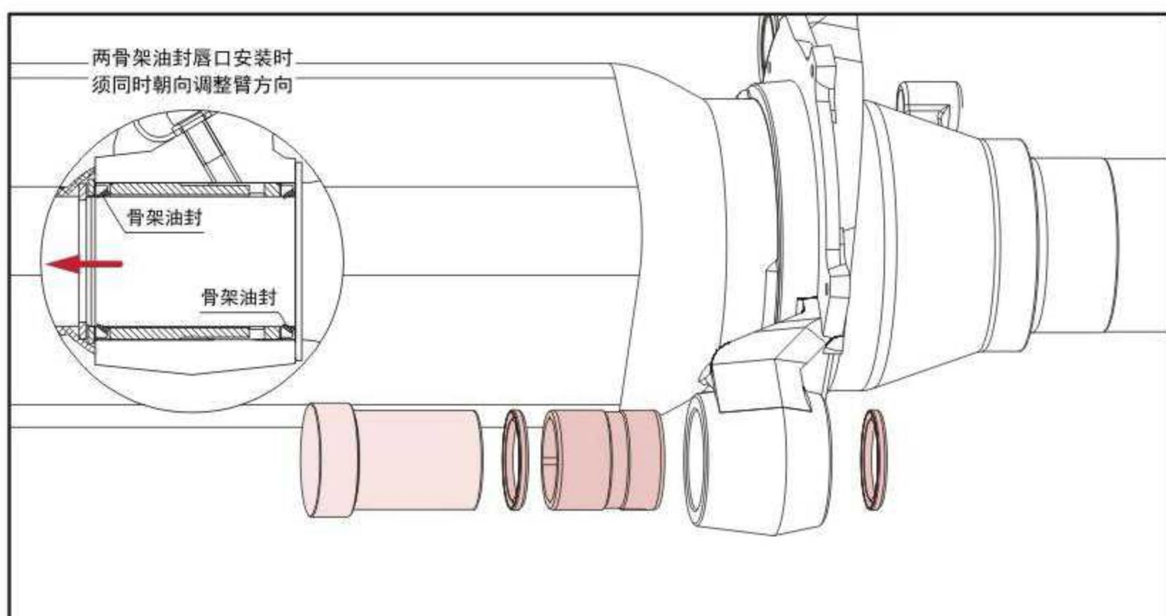
依次安装凸轮轴、垫片、凸轮轴卡簧、凸轮轴挡尘盖和管夹。
