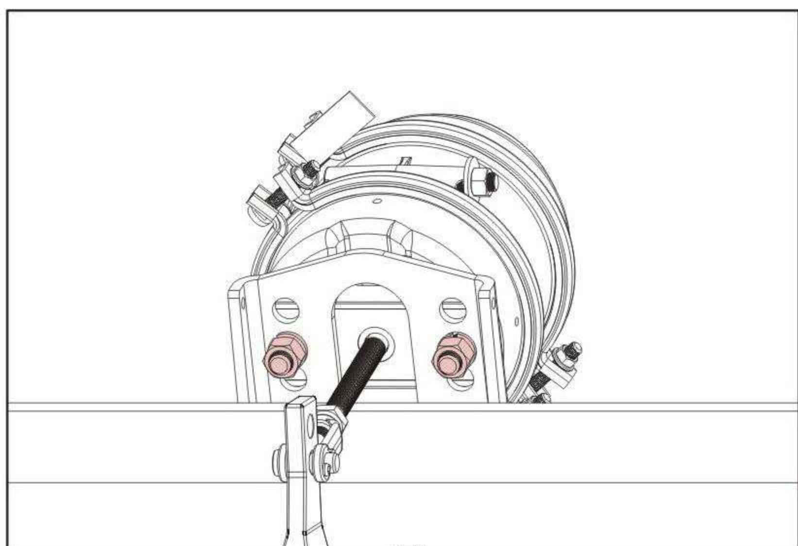
应急环境下，可以使用双气室的螺杆，拧紧时压缩气室后腔的驻车弹簧，从而取消车辆的驻车制动。
