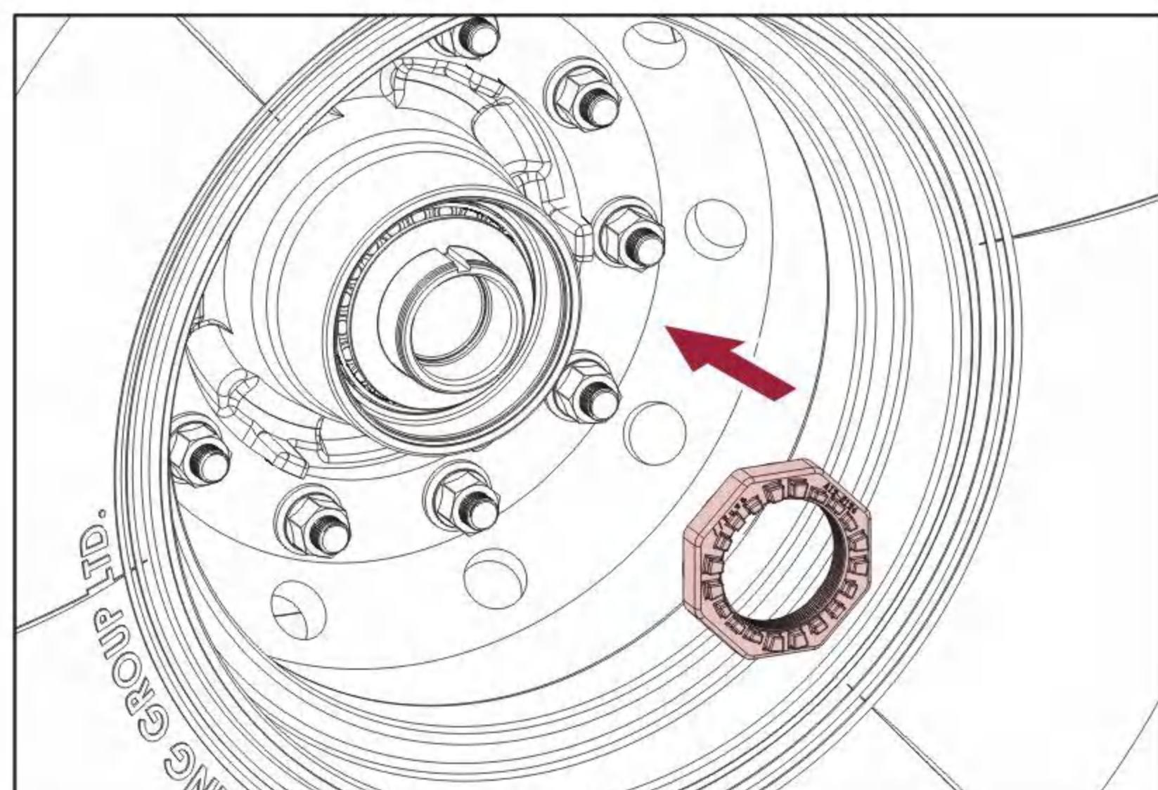
使用扭力扳手以370Nm拧紧轴头螺母，然后回松1/6~1/7圈，装上螺母卡簧。
