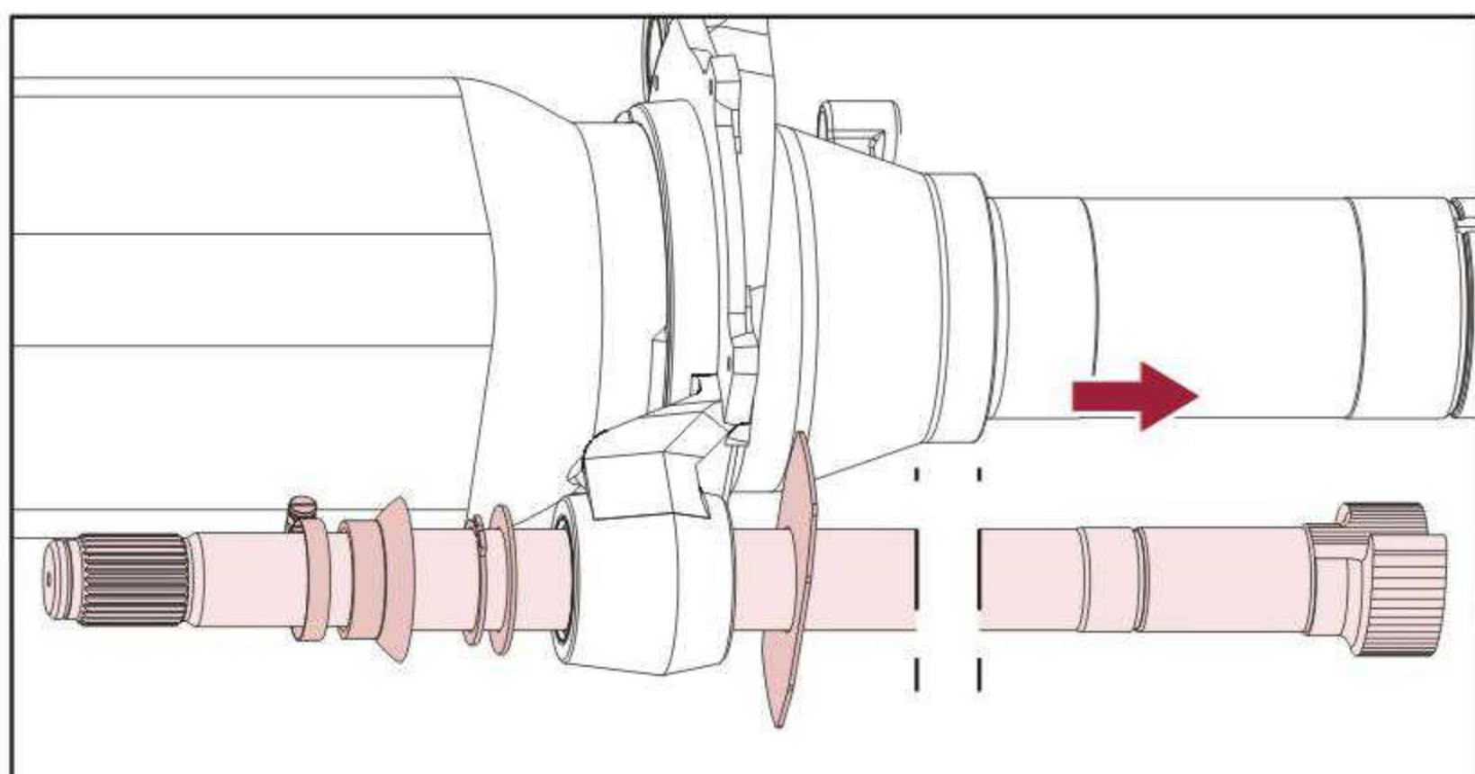
使用工装把凸轮轴骨架油封和衬套敲打出来。
